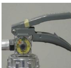
× 安全栓の脱落
