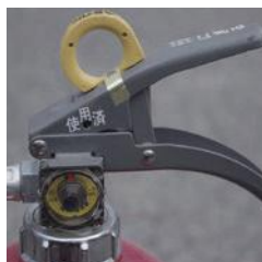
× 表示装置の脱落
