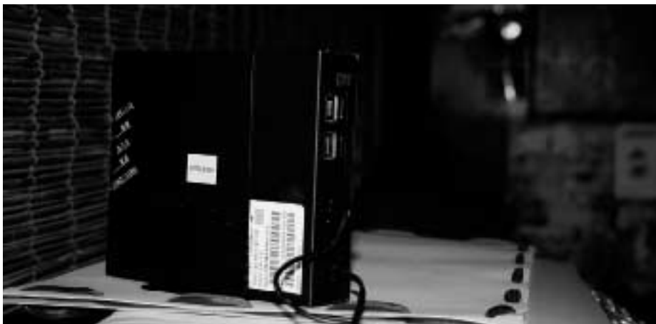
D-ONU (光回線終端装置/光信号を通信の信号に変換する機器)
