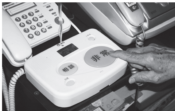
独居老人宅などに設置している緊急通報装置
